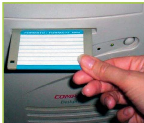
Fig. 6.33. Para expulsar un disquete se debe presionar el botón que tiene la disquetera
