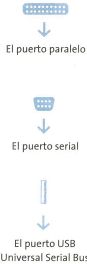
Un puerto es un enchufe en la parte trasera de la computadora donde se conectan los aditamentos externos, tales como impresora, teclado, mouse, escáner o módem. Esto permite el flujo de información e instrucciones entre la computadora y el aditamento conectado.
