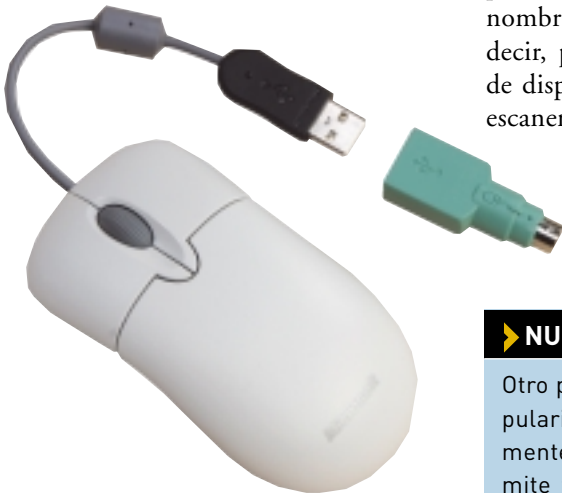
Figura 9. Es posible adquirir adaptadores para conectar dispositivos USB a otros puertos.
