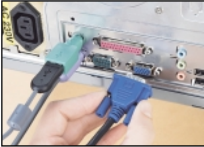
Figura 8. En los motherboards actuales, a cada puerto le corresponde un color. Esto se estableció por convención para poder relacionar al puerto con su correspondiente dispositivo sin cometer errores en la conexión. Por ejemplo, tanto el puerto de la placa de video como el conector del monitor son de color azul.
