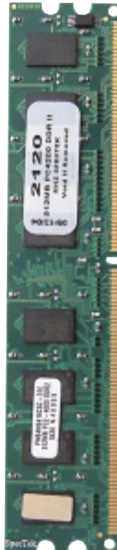
Figura 4. Físicamente, la memoria RAM está formada por una serie de chips agrupados en un módulo de memoria .
