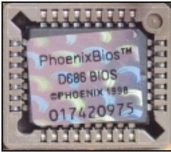
Figura 5. El BIOS es llamado Setup por muchos, dado que en él se establece la configuración que será tomada por la máquina.
