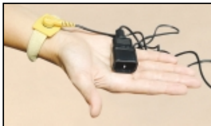
Figura 10. La pulsera antiestática es ideal para trabajar sin riesgo de dañar componentes.
